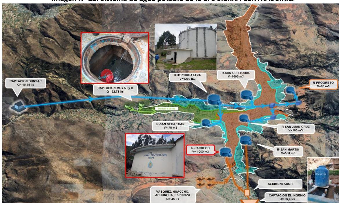
Imagen N° 22: Sistema de agua potable de la EPS SIERRA CENTRAL S.R.L.
